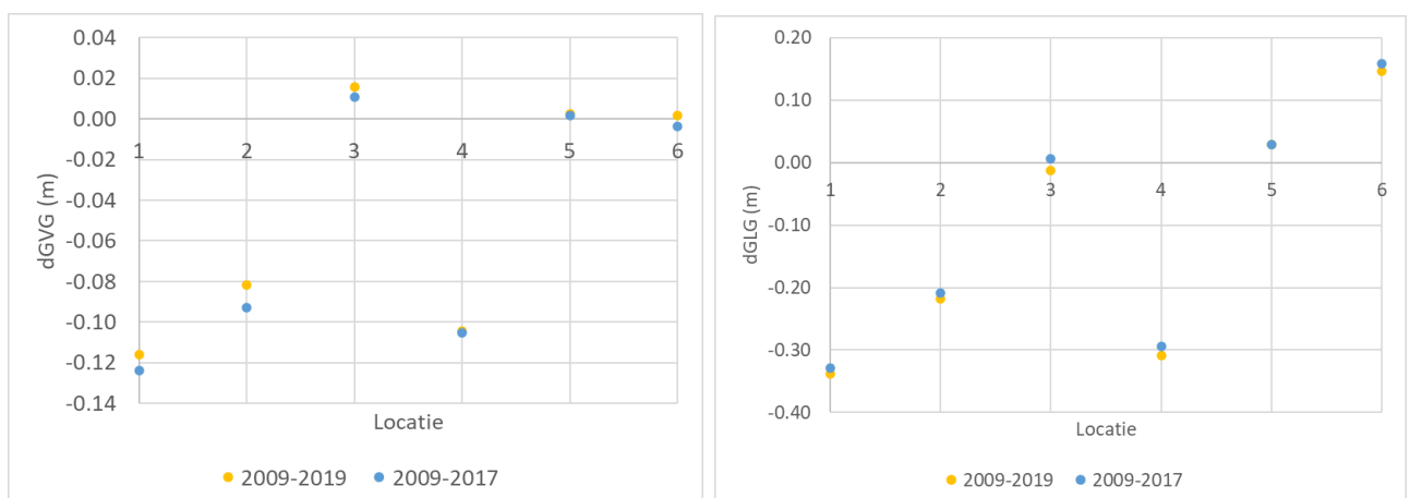
Figuur 3.8 Verskil tussen gemeten en gemodelleerde GVG (links) en GLG (rechts). De gemeten GxG is bepaald door met behulp van Menyantes de meetreeks te verlengen. Zowel de periodes 2009-2017 (blauw) als 2009-2019 (geel) zijn vergeleken. De locaties zijn de meetlocaties DB01 t/m DB06 uit het OBN-project 'Kwantificering kwelfluxen'
